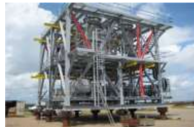
Proceswater zuiveringsinstallatie voor offshore
